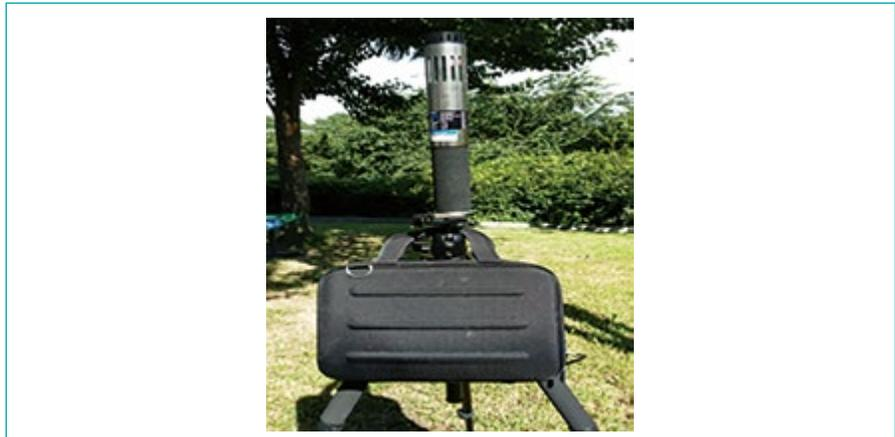
[그림 11] 유해가스 측정을 위한 직독식 기기의 설치
