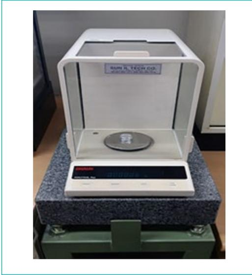
[그림 20] 밸런스 안정을 위한 받침대(대리석) 및 밸런스의 설치예
