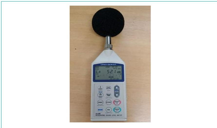
[그림 16] 소음의 지역노출을 측정하기 위한 소음 측정기 (SPL meter)
