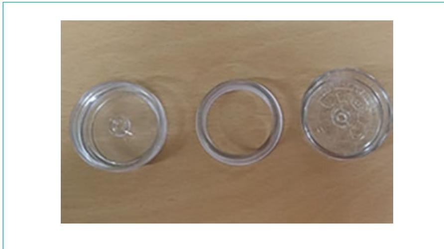
[그림 23] 분진 측정용 필터와 37mm 3단 카세트
