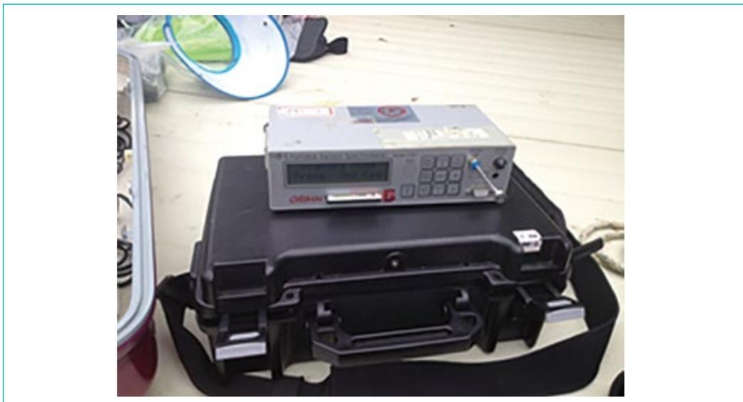
[그림 1] 직독식 기기를 활용한 공기중 분진 농도 측정
