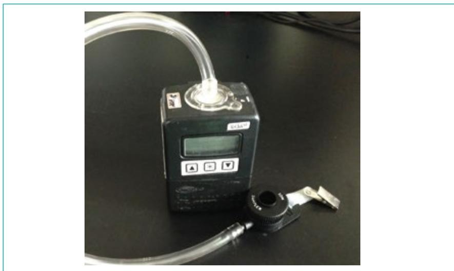
[그림 26] 흉광성 분진용 카세트를 활용한 내독소 분진 측정 필터의 펌프 연결 사례
